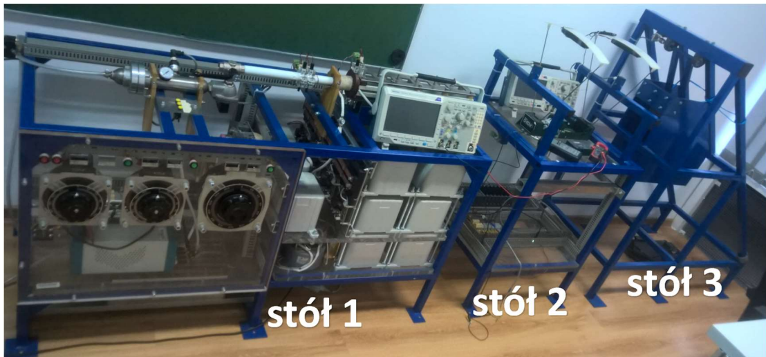
Rys. 2.3. Widok ogólny stanowiska hybrydowej wyrzutni elektromagnetycznej typu PCR zlokalizowanej na trzech niezależnych stołach: 1, 2, 3 (opracowano na podstawie [16])
